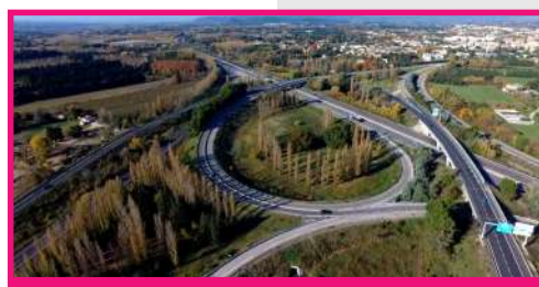
A7/A9 Création d'une bretelle de bifurcation entre l'A7 sud et l'A9 sud. Objectif : permettre aux usagers venant du sud de passer d'une autoroute à l'autre sans sortir à Orange
